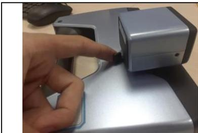
(3) カラーモジュールの固定レバーを右に回して、カメラを適切な位置に固定してください。
