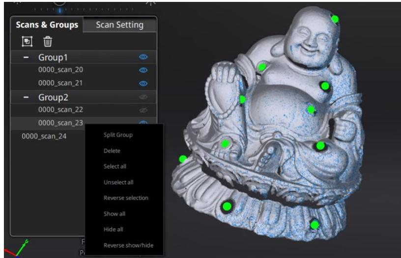
**スキャンデータリスト**：スキャンデータリストに編集したいスキャンデータを左ダブルクリックしてスキャン編集モードに入ります。編集モードでは、選択したデータのみを編集します。
