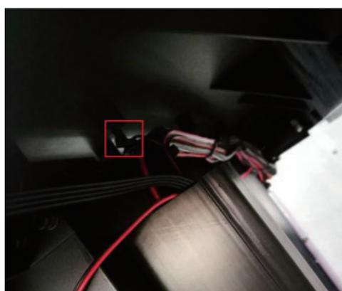
⑦プリンターの背面右側にあるYモーター近くに、カップリングがあります。2本のグラブネジと別の丸頭ネジ2本のネジを外します。(型番によっては4本のグラブネジがあり、丸頭ネジはない場合があります。)
