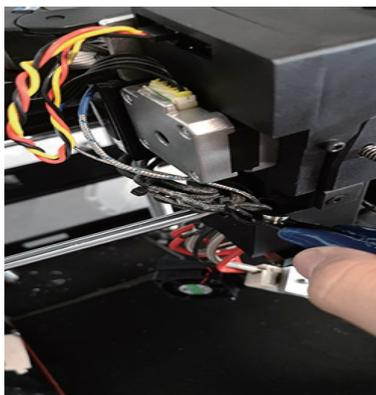
⑥古いフロントファンを取り外し、保護カバーと新しいフロントファンを4本の固定ネジで取り付けます。ラベルのある面がファンダクトに面していることを確認します。
