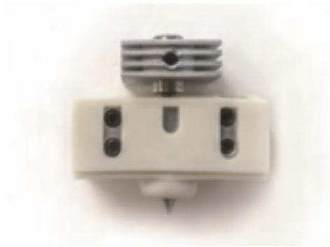
⑥ヒートシンクを下に移動してシリコンカバーの上に置き、所定の位置に締めます。
