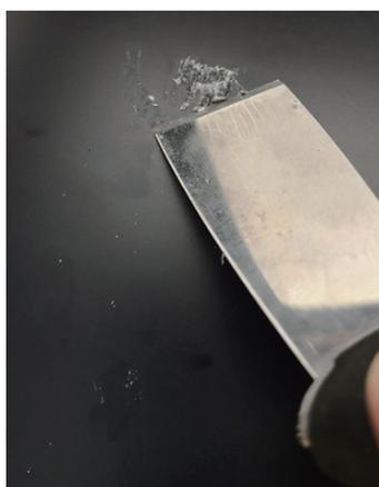
③スクレーパーで拭き取りにくい接着剤がある場合は、プレートを取り付け直し、ベッドの温度を110℃に設定し、30分待ちます。その後、スクレーパーでもう一度試してください。
