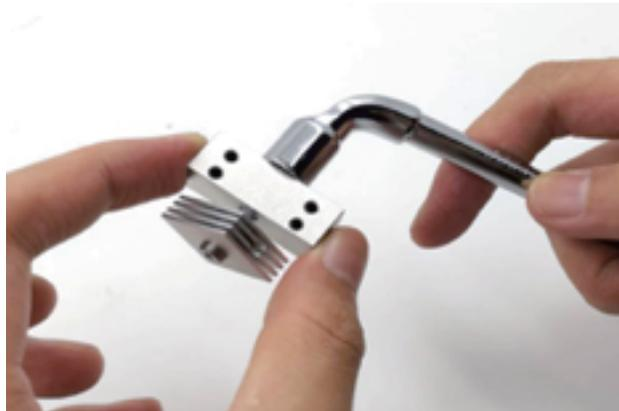
⑤シリコンカバーを再度取り付け、ヒートシンクの固定ネジを緩めます。ノズルヒーターを平らな面に置き、ヒートシンクを回転させて、固定ネジが外側を向くようにします。
