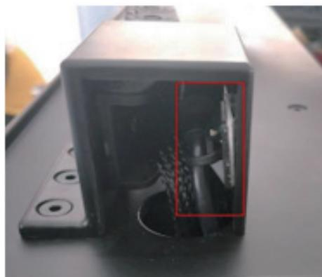
⑤下図に示すチェーンローリング固定ネジを取り外します。
