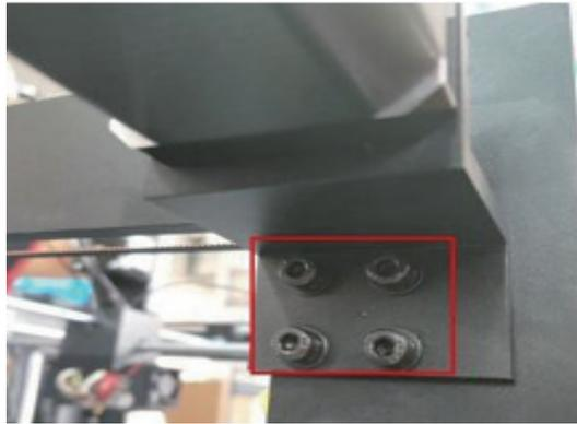
⑨古いカップリングを外し、新しいものに交換します。
