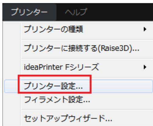
図 8.1: メニューバーから「プリンター」->「プリンター設定」を選択します。
