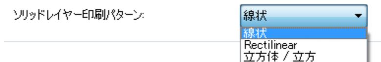
図 5.29：モデルタイプに応じて、充填形状のタイプを選択します。
