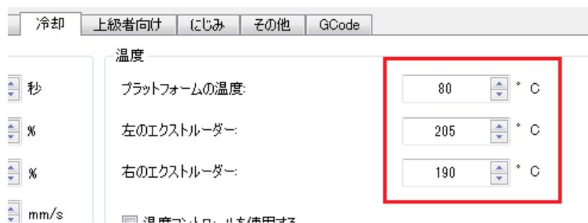
図 6.17：温度がフィラメントに適しているかどうかを確認します。
