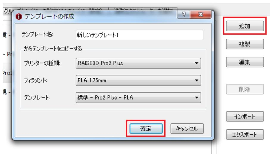
図 5.2：新しいテンプレートを作成する
