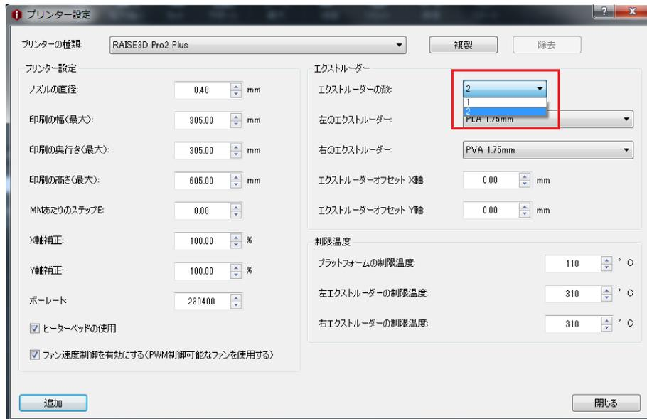
図 6.2: 「エクストルーダーの数」を2に設定し、各エクストルーダーのフィラメントタイプを設定します。
