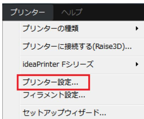
図 6.1：メニューバーの「プリンター」 -> 「プリンター設定」を選択します。
