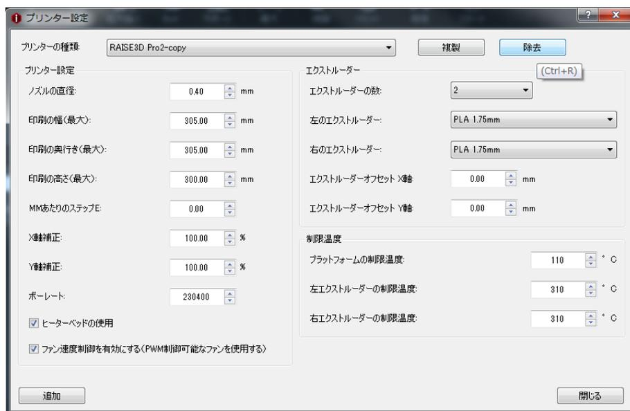
図 8.4：選択したプリンタ設定を削除する。
