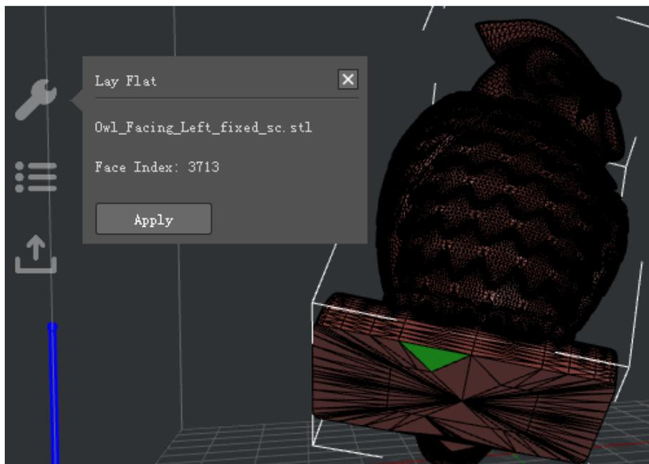
図 4.15：「適用」をクリックして、モデルをプラットフォーム上にフラットに配置します
