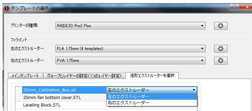
図 6.11：異なるエクストルーダーを選択して、モデルを造形します。
