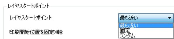
図 5.15：レイヤ開始点には 3 つのタイプがあります。始点タイプとして固定を選択すると、X&Y の値を設定して位置を定義できます。アイデアメーカーは設定した位置に基づいて最も近い位置を設定します。
