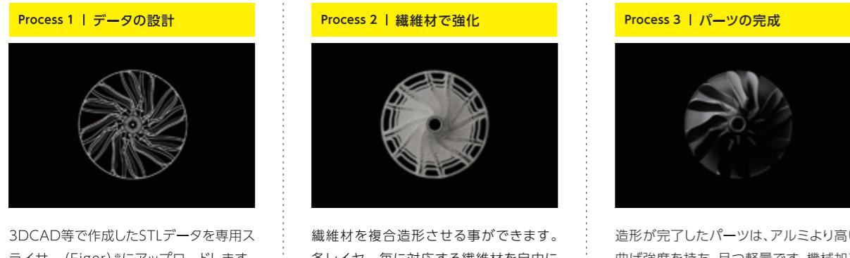
3DCAD等で作成したSTLデータを専用スライサー(Eiger)<sup>\*</sup>にアップロードします。造形したい材質を選択しスライシングを開始します。※P10
