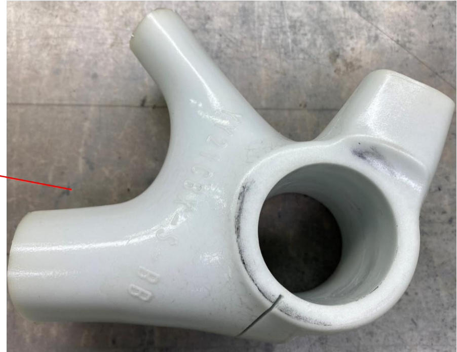
ウレタン カーボンプリプレグを巻き付ける
