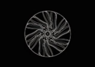
3DCAD等で作成したSTLデータを専用スライサー(Eiger)\*にアップロードします。造形したい材質を選択しスライシングを開始します。※P10
