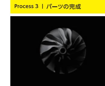
造形が完了したパーツは、アルミより高い曲げ強度を持ち、且つ軽量です。機械加工された治具等の置き換えとして、造形台から取り外してすぐに使用可能です。
