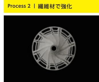
繊維材を複合造形させる事ができます。各レイヤー毎に対応する繊維材を自由に複合させて造形しています。
