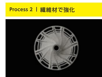
繊維材を複合造形させることができます。各レイヤー毎に対応する繊維材を自由に複合させて造形しています。
