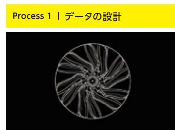
3DCAD等で作成したSTLデータを専用スライサー(Eiger)\*にアップロードします。造形したい材質を選択しスライシングを開始します。※P10
