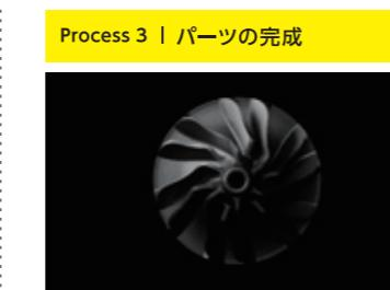
造形が完了したパーツは、アルミより高い曲げ強度を持ち、且つ軽量です。機械加工された治具等の置き換えとして、造形台から取り外してすぐに使用可能です。
