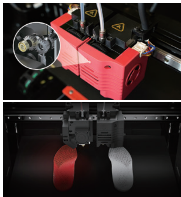
IDEX (独立型デュアルエクストルーダー) による同時造形
