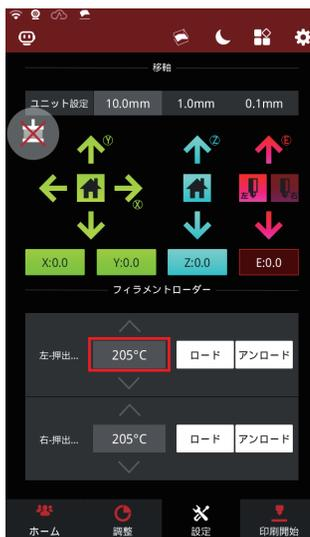
②ノズルを適切な温度に設定します。例えば、Raise3D PLA のデフォルトのロード/アンロード温度は 215°Cです。ここでは、左ノズルを例に、左ノズルの温度を 215°Cに設定します。
