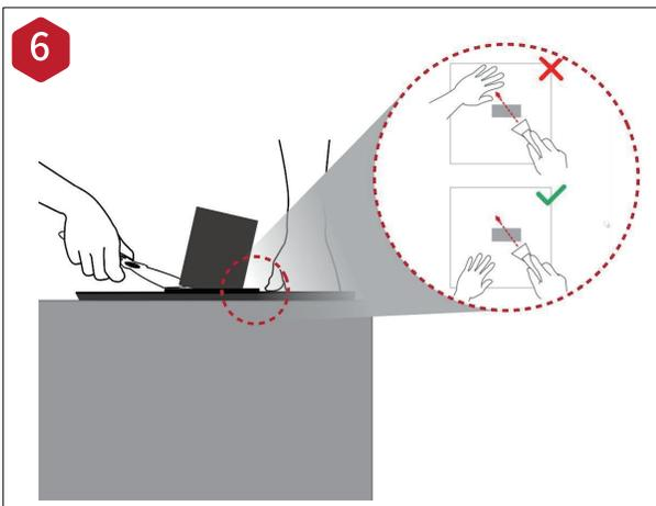
片手でフレキシブルプレートに手を置き、もう片方の手でスクレイパーを使ってモデルを取り外します。
