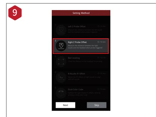
「右プローブオフセット」は右ノズルとフレキシブルプレートの距離を調整します。
