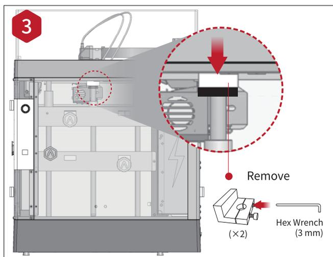
左右のZ軸ボールネジを固定するためにそれぞれクランパーが1個ずつ付けられています。それぞれのクランパーは2つの六角ネジで固定されていますので、付属の3mm六角レンチで外してください。
