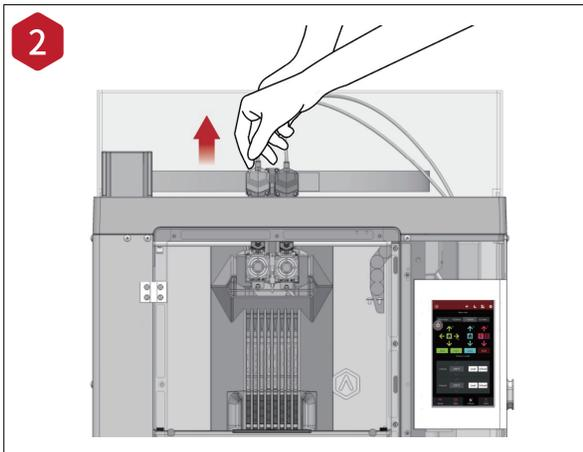
エクストルーダーのクイックコネクタを押しながら、フィラメントガイドチューブを引き抜きます。
