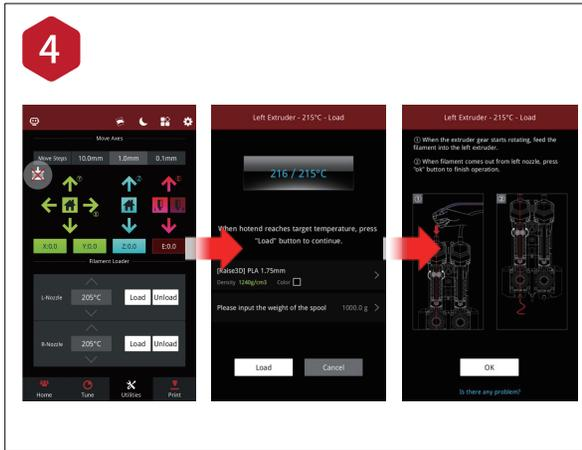
左のエクストルーダーにフィラメントをセットした後、画面下の「設定」を選択し、左ノズル温度を使用するフィラメントに適した造形温度に設定します。
