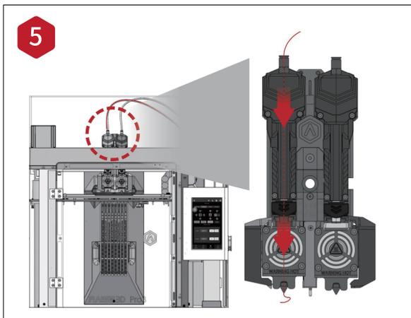
エクストルーダーのギアが回転し始めます。フィラメントを手でゆっくりとエクストルーダーに押し込みます。ノズルからフィラメントが押し出されたら、「OK」を選択してロードを完了します。ガイドチューブをクイックコネクターに戻します。
