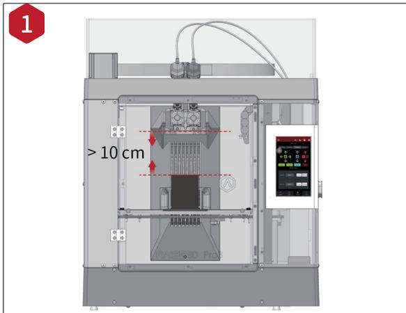
プリンターがアイドル状態であることを確認し、造形物上部とノズルの間に 10cm 以上の隙間を空けてください。
