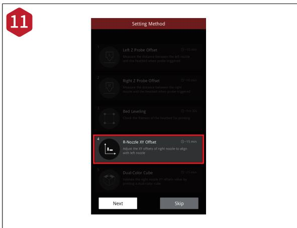
「右ノズル XY オフセット」は左右のノズル XY 位置を調整します。デュアル造形時にズレが生じないようにします。
