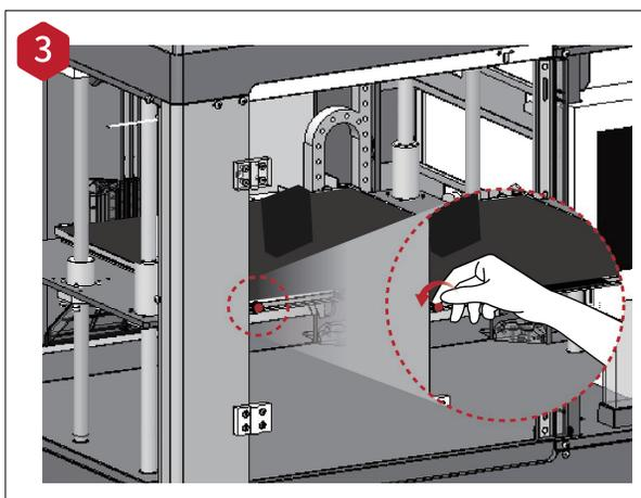
赤い手回しネジ 2 個を反時計方向に回して緩めます。赤い保護ハンドルを持ち、フレキシブルプレートを軽く持ち上げ、プリンターから取り出します。
