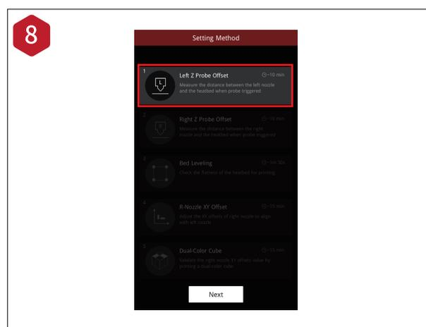
「左プローブオフセット」は左ノズルとフレキシブルプレートの距離を調整します。
