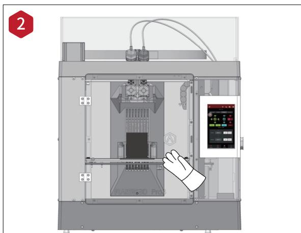
フレキシブルプレートとノズルが常温になってから、造形物を取り外してください。十分に冷める前に造形物を取り外す場合は、付属の耐熱手袋を着用するなどし、火傷にはご注意ください。
