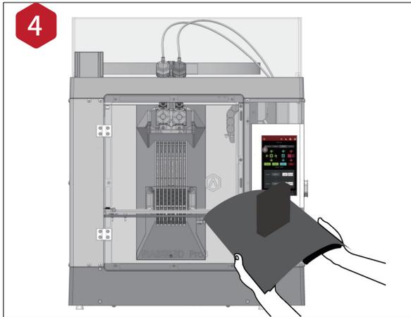
左図のようにフレキシブルプレートごと曲げて戻す作業を、外れるまで繰り返し曲げます。
