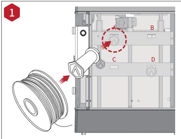
フィラメントホルダーを取り付けて、ホルダーにフィラメントのスポールを設置します。
