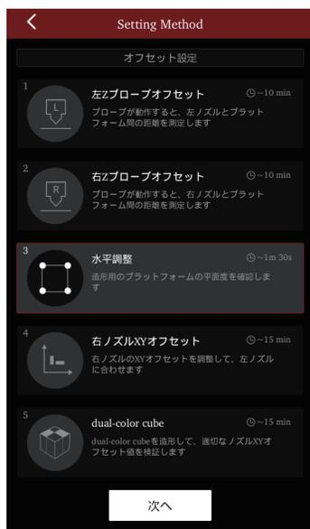
②「次へ」を選択しますと自動で水平調整が開始されます。
