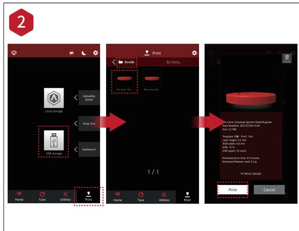
タッチパネル画面右下にある「印刷開始」を選択し、「USB ストレージ」を選択します。造形データを選択し、「印刷」を選択すると造形が開始されます。
