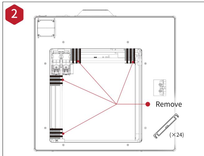
プリンターの電源を入れる前に黄色のステッカーと24個のクリップを外してください。クリップを外さないとプリンターが破損する恐れがあります。クリップは保管しておき、プリンターを輸送する際は再度取り付けてください。
