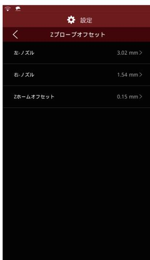
③左もしくは右のノズルとプレートの距離が離れすぎている場合は数値を上げ、逆に近すぎる状態の場合は数値を下げて入力します。(0.1mm前後の数値で微調整をしてください。)
