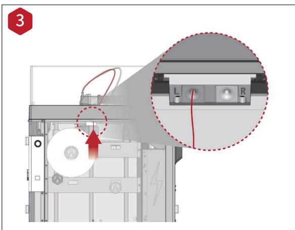
フィラメントの端を左右のインレットに通し、ガイドチューブに通します。
