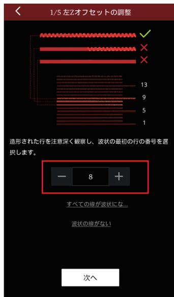
⑥造形が完了したら端から端まで綺麗に波打っている線を見つけます。
