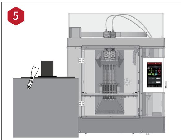
フレキシブルプレートを何度か曲げてみても造形物を取り外せない場合は、付属のスクレイパーを使って取り除いてください。
