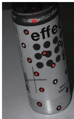
マーカーポイント貼り付け
