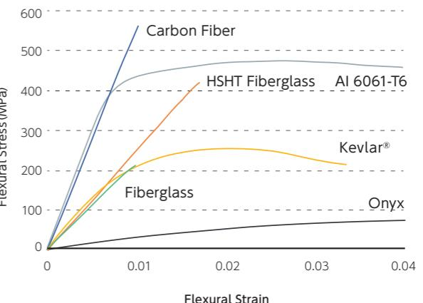
Markforgedの代表的な樹脂材料Onyxは、微細な炭素繊維が含まれたナイロンベースのフィラメントで、美しい表面品質と高い精度、そして優れた強度を兼ね備えています。Onyxをはじめとした樹脂材料に、さらに繊維材料としてカーボンファイバーを添加して造形した場合、形状や応力方向によってはアルミ(AI 6061-T6)を超える強度を実現することができます。また、カーボンファイバー以外の繊維材料を使用することも可能で、ファイバーの量を調節することで、様々な強度や韌性を持った部品を作りあげることができます。
