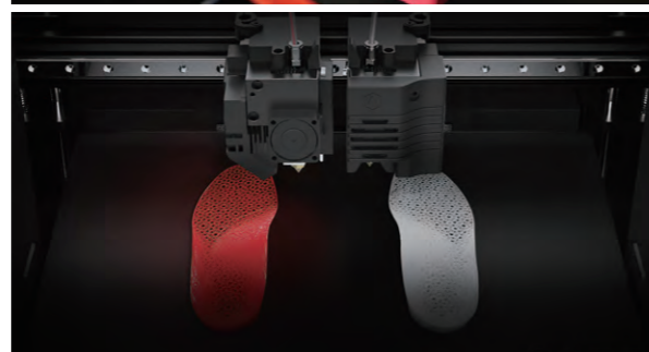
IDEX (独立型デュアルエクストルーダー) による同時造形
