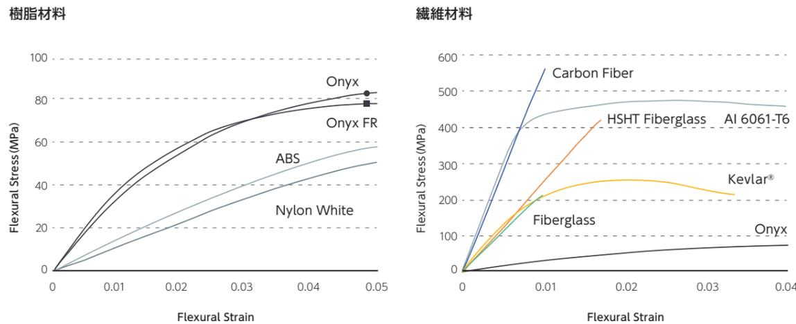
Markforgedの代表的な樹脂材料Onyxは、微細な炭素繊維が含まれたナイロンベースのフィラメントで、美しい表面品質と高い精度、そして優れた強度を兼ね備えています。Onyxをはじめとした樹脂材料に、さらに繊維材料としてカーボンファイバーを添加して造形した場合、形状や応力方向によってはアルミ(Al 6061-T6)を超える強度を実現することができます。また、カーボンファイバー以外の繊維材料を使用することも可能で、ファイバーの量を調節することで、様々な強度や靱性を持った部品を作りあげることができます。
