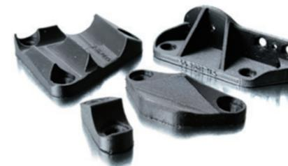
従来、オフロードトラック用荷台ラックの溶接中の固定治具として、鋼板を使用し固定していました。しかしこの方法では、曲がった溶接・タッキング(仮付溶接)等によって手作業で固定治具を製作しなければならず、再現性の低さや、人為的ミスがあり、品質低下の原因を持っていました。Markforged Mark Twoの難燃性短炭素繊維プリント部品によって、固定具は手作業で製作する必要がなくなり、溶接部品に合わせた、より効果的な固定具を製作できるようになりました。
