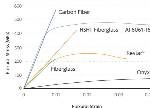
Markforgedの代表的な樹脂材料Onyxは、微細な炭素繊維が含まれたナイロンベースのフィラメントで、美しい表面品質と高い精度、そして優れた強度を兼ね備えています。Onyxはじめとした樹脂材料に、さらに繊維材料としてカーボンファイバーを添加して造形した場合、形状や応力方向によってはアルミ(Al 6061-T6)を超える強度を実現することができます。また、カーボンファイバー以外の繊維材料を使用することも可能で、ファイバーの量を調節することで、様々な強度や韌性を持った部品を作りあげることができます。
