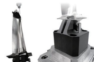
CMM(三次元測定機)の部品固定治具は、高いレベルの精度を確保するために、たわみを最小限に抑える必要があります。従来の治具製作では金属を複数回にわたる荒削りと磨きの作業が必要であり、製作の待ち時間がワークフローのボトルネックとなっていました。
