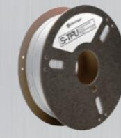
ショアA硬度95、破断伸び率500%以上のTPU素材です。柔軟性を持ったパーツを少量から製造したい場合に適しています。
